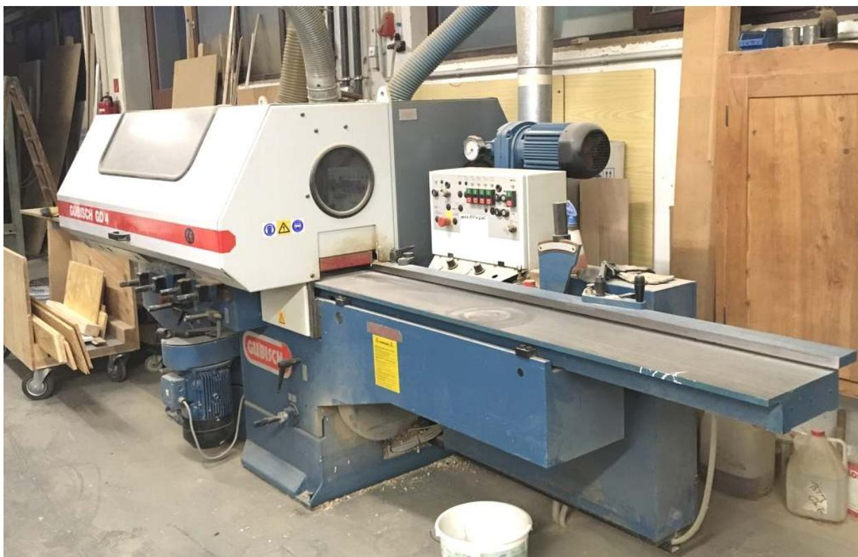
mit 4 Spindeln zum Abrichten, Fügen sowie Profilieren
