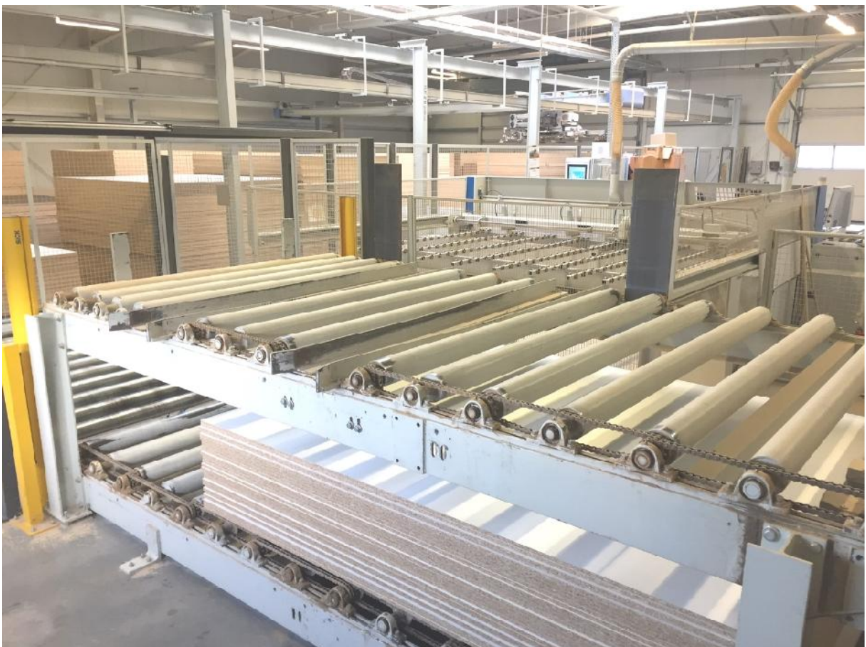
Etagenrollenbahn linksseitig an Hubtisch angeordnet mit angetriebenen Schwerlastrollen
